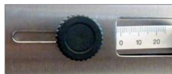
L'échelle à droite, à côté de la vis de réglage, montre le dépassement en millimètres, mesuré à partir de l'arête extérieure du joint scellé.
