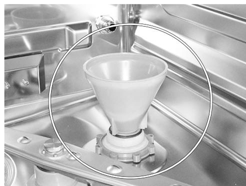
6. Retirez la trémie de remplissage et l'excès de sel de la chambre de lavage.
