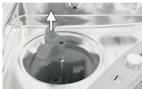
3. Nettoyez le clapet anti-retour sous de l'eau courante. N'utilisez pas de produit de vaisselle !
