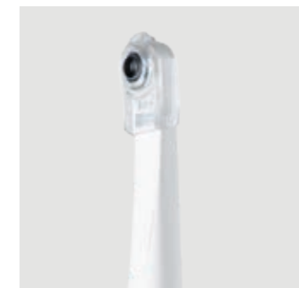
Macro Cap Macro Cap est un accessoire extrêmement utile car il offre des agrandissements jusqu'à 100x en très haute résolution. Il optimise l'éclairage de détails rapprochés du groupe optique grâce aux 3 lentilles supplémentaires en verre de haute pureté.
