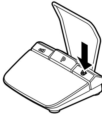
Pendant le traitement, le sens de rotation du moteur peut être modifié à l'aide de la touche Sens de rotation du moteur située sur le rhéostat au pied sans fil. La modification du sens de rotation du moteur s'affiche à l'écran. Pour des raisons de sécurité, la marche à gauche n'est pas enregistrée.
