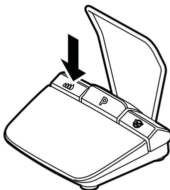
Pendant le traitement, le débit de produit réfrigérant peut être défini et activé ou désactivé à l'aide de la touche Pompe du rhéostat au pied sans fil. Il existe deux modes de fonctionnement pour la touche Pompe.
