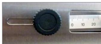
L'échelle à droite, à côté de la vis de réglage, montre le dépassement en millimètres, mesuré à partir de l'arête extérieure du joint scellé.
