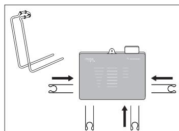
Prendre un tube pompe péristaltique en silicium et l'insérer dans le connecteur du cordon de la pièce à main;
