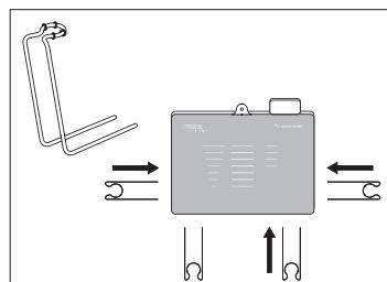
Prendere un tubo pompa peristaltica in silicone e inserirlo sul connettore del cordone del manipolo;
