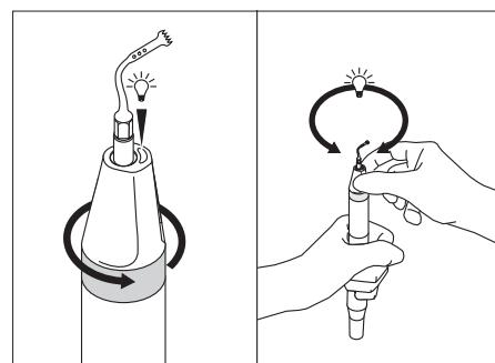
La posición de la luz de LED en el terminal anterior de la pieza de mano es regulable de la siguiente manera:
