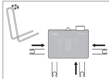
Tomar un tubo de silicona de la bomba peristáltica e introducirlo en el conector del cordon de la pieza de mano;
