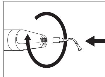
Avvitare l'inserto prescelto sul manipolo PIEZOSURGERY® touch fino a portarlo in battuta;
