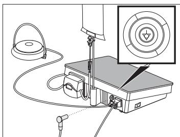
Nettoyer le clavier touch avec un chiffon doux, laissant peu de résidus de fibre, et placer la pellicule stérile de protection sur la surface du clavier touch propre.
