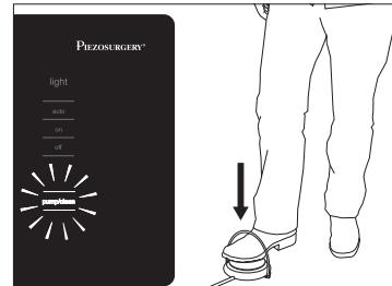
Non appena la pompa peristaltica entra in funzione viene illuminata l'intera scala di valori della sezione "irrigation" e durante il passaggio del liquido il valore dell'irrigazione passa da 6 a 0;
