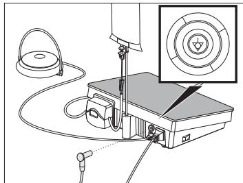
Reinigen Sie das Bedienfeld mit einem weichen, fusselarmen Tuch und legen Sie die sterile Schutzfolie auf die saubere Bedienfeldoberfläche.
