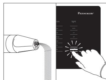
Il ciclo può essere interrotto non appena si vede uscire il liquido dal manipolo PIEZOSURGERY® touch, premendo nuovamente su PUMP/CLEAN o in alternativa premendo sul pedale. La funzione PUMP viene disattivata, la tastiera ritorna ad essere attiva riposizionandosi sull'ultimo settaggio usato;
