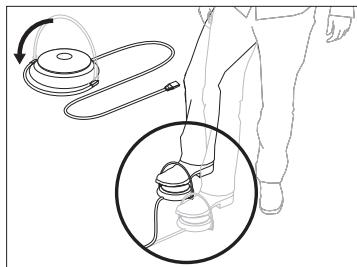
**OBSERVERA** pedalen är försedd med ett fäste som tillåter dess förflyttning till det mest lämpliga läget för operationen, utan att behöva röra vid den med händerna för att flytta den;
