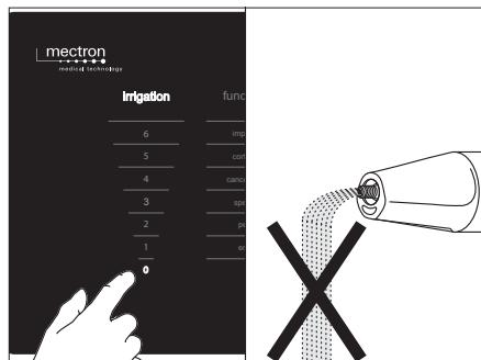
Om en irrigation under 8 ml/min krävs, använd "bone grafting kit" (tillbehör som kan beställas separat) genom att föra in det mellan droppslangen och handstyckets silikonslang, låt den sedan passera genom den peristaltiska pumpen och välj 1 för irrigationsnivå.
