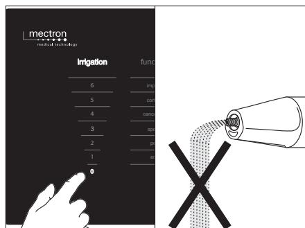
En caso de que fuese necesario un caudal de irrigación inferior a 8 ml/min, utilizar el “bone grafting kit” (accesorio que se puede pedir por separado) introduciéndolo entre el regulador de flujo y el tubo de silicona de la pieza de mano, haciéndolo pasar a través de la bomba peristáltica y seleccionando en 1 el nivel de irrigación.
