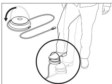
**NOTA BENE** il pedale è dotato di una staffa che permette lo spostamento dello stesso nel luogo più idoneo per l'operazione, senza necessità di toccarlo con le mani per spostarlo;
