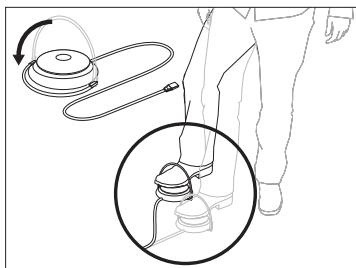
**À NOTER** la pédale est dotée d'un étrier qui permet de la déplacer vers l'endroit plus adapté à l'opération, sans avoir à la toucher avec les mains;
