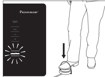
När den peristaltiska pumpens funktion startar lyser hela värdeskalan för sektionen "irrigation" och under vätskans passage skiftar värdet för irrigationen från 6 till 0;
