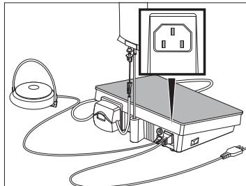
Erdungskabel: das Gerät ist auf der Rückseite mit einer zusätzlichen Erdungssteckdose ausgerüstet. Diese Steckdose entspricht der DIN 42801. Der Stecker des (optionalen) Erdungskabels wird in die Steckdose auf der Geräterückseite eingeführt. Zweck der Erdungsverbindung ist die Reduktion von während des Betriebs auftretenden Potenzialunterschieden zwischen dem Gerätegehäuse und leitenden den Teilen anderer Gegenstände im medizinischen Umfeld;
