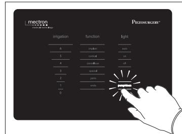
Pendant que le voyant PUMP/CLEAN clignote, appuyer sur la pédale une fois et relâcher, PUMP/CLEAN arrête de clignoter et le circuit d'irrigation commence à se remplir;
