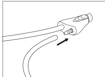
Introducir el conector de la pieza de mano con la palabra UP hacia arriba en el interior del conector que se encuentra en la parte frontal del PIEZOSURGERY® touch;
