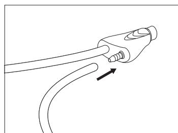
För in handstyckets kontakt med texten UP uppåtvänd i kontakten som är placerad på framsidan av PIEZOSURGERY® touch;
