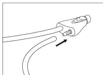
Inserire il connettore del manipolo con la scritta UP rivolta verso l'alto all'interno del connettore che si trova nella parte frontale del PIEZOSURGERY® touch;
