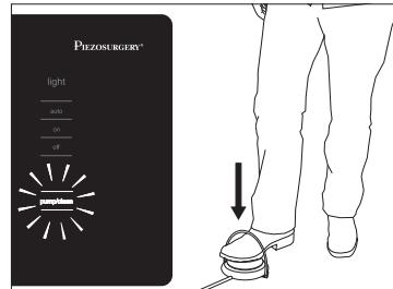
Sobald die Peristaltikpumpe in Betrieb gesetzt wird, leuchten sämtliche Werte aus dem Abschnitt "irrigation" auf. Während des Flüssigkeitsaustritts ändert sich der Wert des Durchflusses von 6 auf 0;
