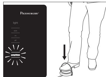
En cuanto la bomba peristáltica entra en funcionamiento se ilumina toda la escala de valores de la sección "irrigation" y durante el paso del líquido el valor de la irrigación pasa de 6 a 0;
