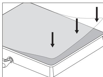
Pulire la tastiera touch con un panno morbido a basso rilascio di fibre e posizionare la pellicola sterile protettiva sulla superficie della tastiera touch pulita.
