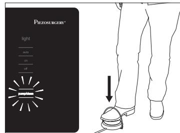
Dès que la pompe péristaltique entre en marche, l'échelle des valeurs de la section "irrigation" s'allume et durant le passage du liquide les valeurs de l'irrigation passent de 6 à 0;
