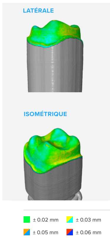
Figure 3. Exactitude de l'impression 3D : Surface des lignes marginales et des dies.
