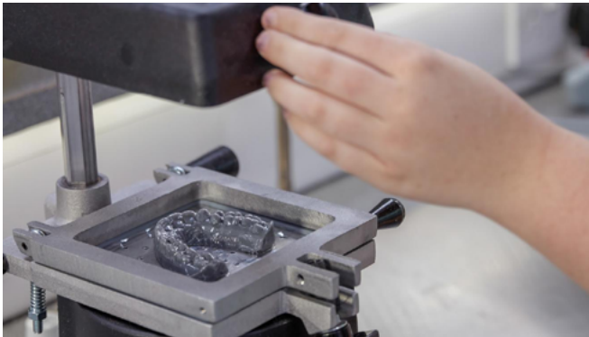
Les attaches orthodontiques et aligneurs transparents sont produits par thermoformage sur des modèles traditionnels en plâtre ou imprimés en 3D.
